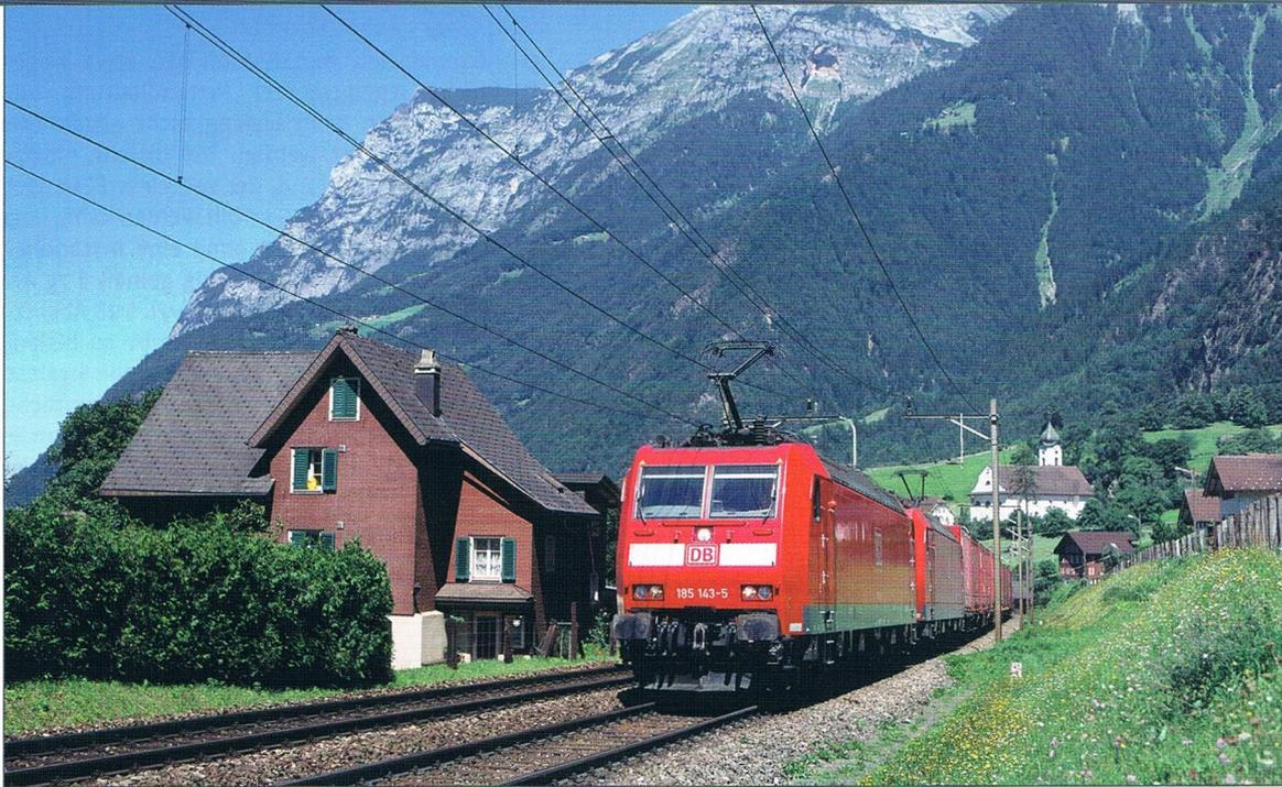
**BILD 2: DB Schenker Rail - Ellok BR 185 mit Güterzug auf dem Netz der SBB [Schweiz]**
